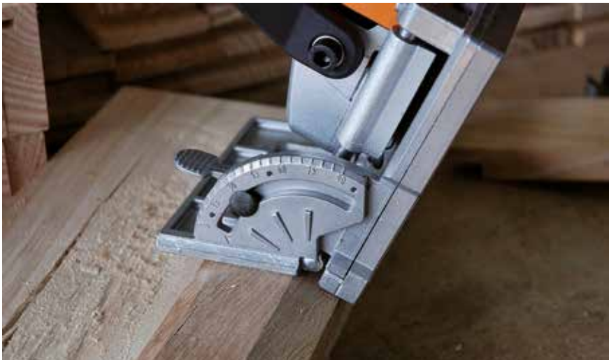
Franchement plus délicat de réglage... l'entaillage sur un chant biseauté ! Nous nous contenterons de dire que ce n'est sûrement pas un exercice de débutant et qu'il vous faudra, pour un travail propre, non seulement une grande précision, mais aussi un parfait calage de la machine.
