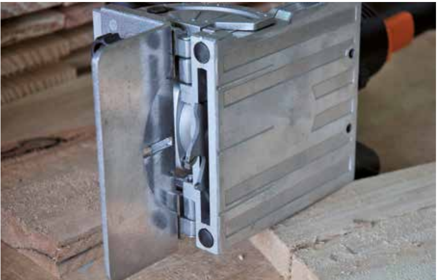
Cette vue de dessous vous permet d'apercevoir la plaque de réglage de hauteur et la fraise d'entaille sortie (diamètre de 100 mm, munie de 6 dents à pastilles de carbure rapportées).
