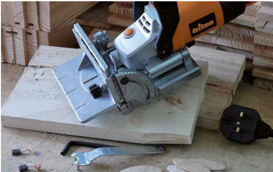
La machine est livrée avec deux clefs de service et deux charbons de rechange ( !...). Comme avec toutes les machines en provenance d'Angleterre, il faudra penser à démonter la prise de branchement pour retrouver à l'intérieur la prise standard.
