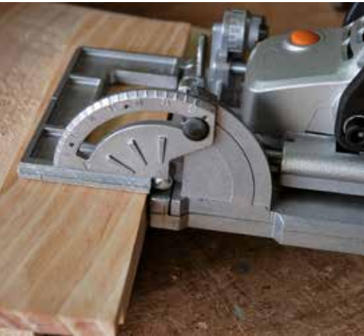
Dans son principe, la fraiseuse d'entaille vient prendre appui sur le bois. Il suffit alors, moteur en marche, de pousser sur le bloc-moteur pour faire pénétrer la fraise dans le bois... et l'entaille est faite. Le réglage de la hauteur se fait toujours à partir de la face de référence.
