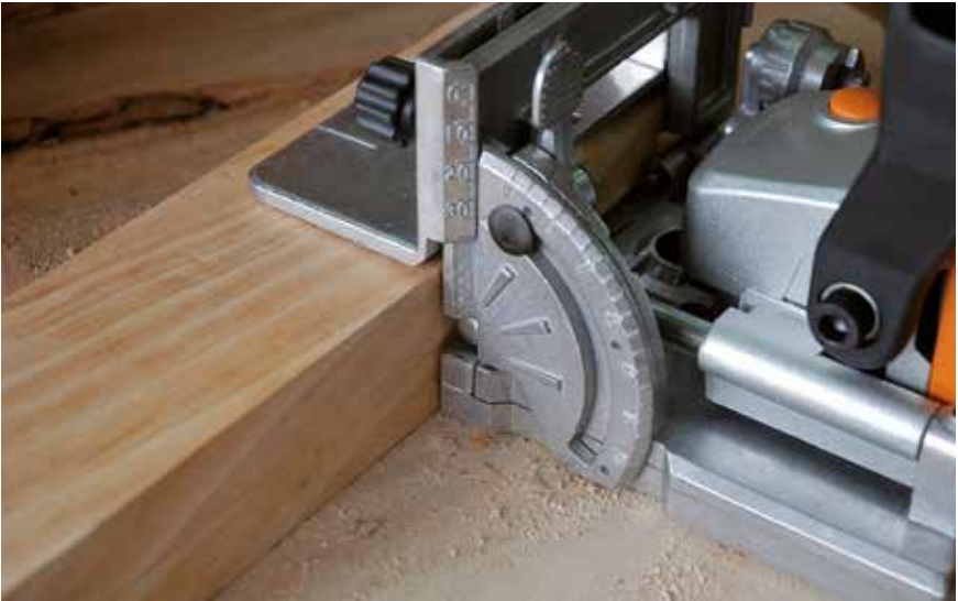
Lorsque le bois est plus épais, il faut utiliser une butée de hauteur réglable (de 0 à 40 mm) et remonter la plaque de hauteur standard à la verticale pour que puisse venir s'y fixer la plaque de butée de hauteur réglable.
