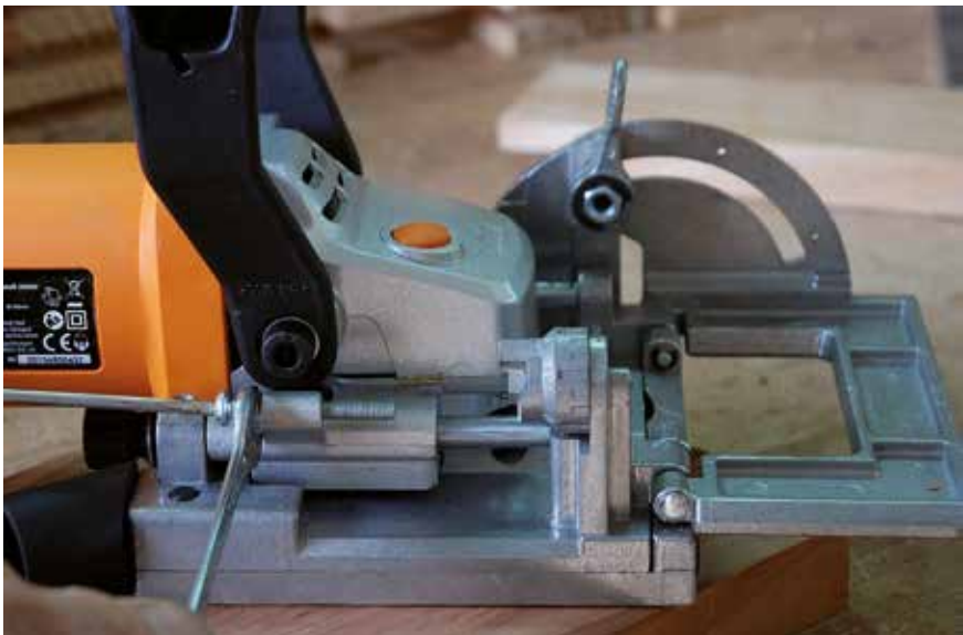
Si l'envie vous prend de vouloir afficher d'autres valeurs, il vous suffira de vous munir d'une clef de 8 et d'un tournevis cruciforme. Vous obtiendrez rapidement d'autres valeurs.
