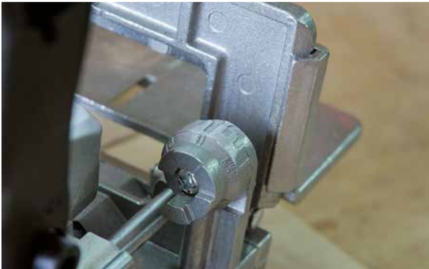
Vous pouvez apercevoir, sur cette vue, la tourelle réglable de la profondeur de pénétration de la fraise selon que vous utilisez des lamelles n° 0, n° 10 ou n° 20. Vous pouvez aussi théoriquement déterminer d'autres valeurs, mais, dans la pratique, vous n'en aurez pas l'utilité.
