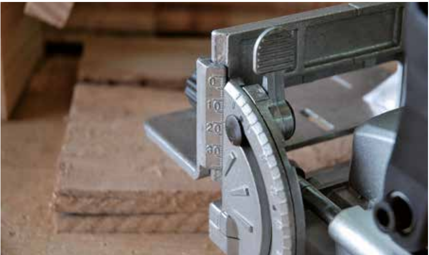
Des indications de hauteur gravées dans l'alu permettent un réglage rapide et relativement précis. De toute manière, comme l'entailage se fait toujours par rapport à la même face de référence, il n'est pas besoin d'avoir une grande précision.
