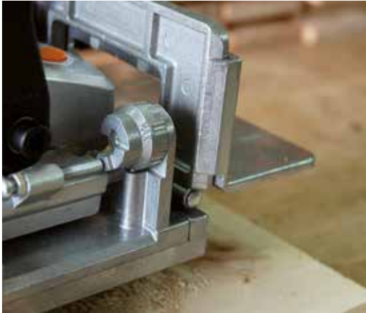
La tourelle de pré réglage est véritablement très pratique : pour obtenir la valeur désirée (0, 10 ou 20), il suffit de la tourner d'un cran. C'est instantané et d'une parfaite fiabilité.
