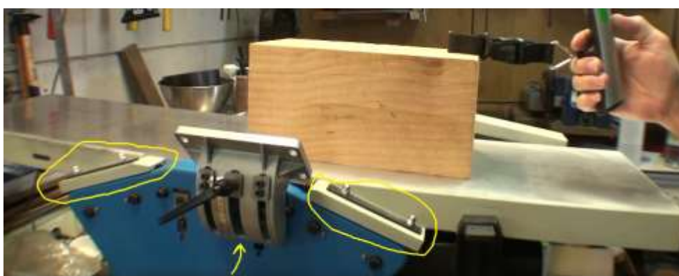
Photo 4 : Ce guide latéral est d'ailleurs fixé/réglé par une pièce plus massive que dans les autres cas (voir flèche). A quoi servent les pièces vissées de part et d'autre de la fixation du guide latéral (cfr cercles jaunes) ? A régler les tables de dégauchissage ? Qui peut le dire ?
