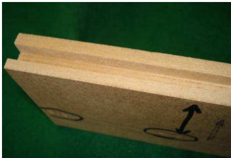
Rainure dans le bas du gabarit
