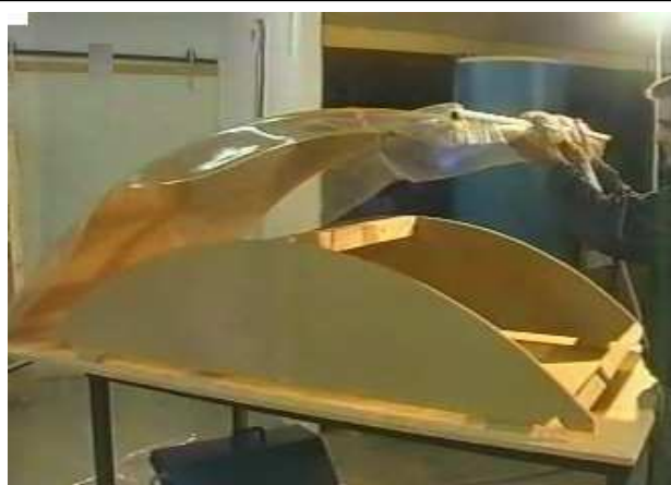
Démoulage de la pièce finie. Notez les 3 barres Assurant la rectitude – une en haut, et les autres aux emplacements des serre-joints de maintien
