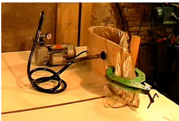
Maintien à l'aide d'un serre-joint pendant la période de séchage de la colle.
