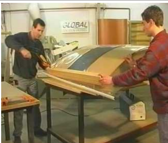
Maintien à l'aide de serre-joints. La bande foncée dans la poche est du tissu 'poumon'.
